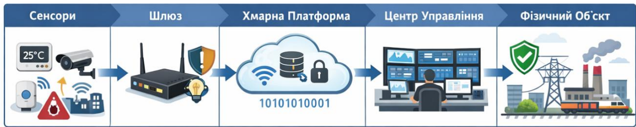
Рисунок 1. Узагальнена архітектура IoT у складі кіберфізичної системи
