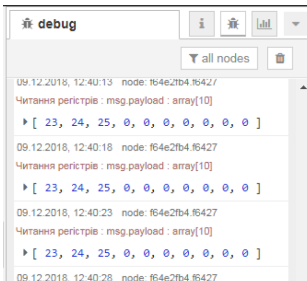
Рисунок 2.13 – Відображення результату зчитування у вікні Debug: масив значень реєстрів
