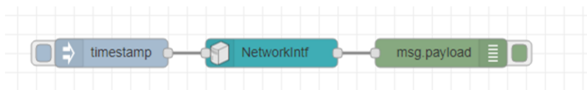
Рисунок 1.13 – Потік із використанням вузла Networkintf
